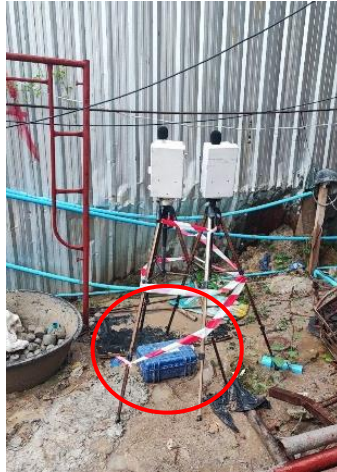
รูปที่ 3.15 การตรวจวัดความสั่นสะเทือน บริเวณพื้นที่โครงการ
