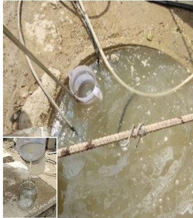
รูปที่ 3.17 การเก็บตัวอย่างคุณภาพน้ำทิ้ง บริเวณระบบบำบัดน้ำเสียสำเร็จรูป
